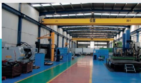
Empresa dedicada al mecanizado de pieza mediana y grande. Dispone de torneado hasta Ø 4.000 x 2000 mm y 20 Tn. y mecanizado de ejes hasta Ø 900 x 5000 mm. Realizan la construcción de la pieza desde el acopio del material hasta la entrega final.
