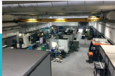
Empresa especialista en mecanizados de precisión y mantenimiento de utillajes. Dispone de una plantilla media de trece personas, y veinte máquinas (centros de mecanizados de 5, 4 y 3 ejes, tornos CNC, tornos convencionales, máquinas de corte por hilo y electroerosión, rectificadora y maquina de medición 3D) distribuidas en un pabellón de 900 m<sup>2</sup>. Sus principales sectores clientes son el aeronáutico y el de automoción. Realizan trabajos en aceros, aluminio y plásticos.
