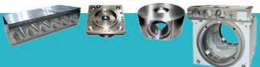
M.M.DE PRECISIÓN es una empresa especialista en trabajos de mecanizado y mandrinado de alta precisión. Obtiene acabados en concentricidades y geometría de entre 0,002 a 0,005 mm. Cuenta con un equipo altamente cualificado de 11 personas y puenteadoras de precisión en atmósfera controlada en unas instalaciones de 700 m<sup>2</sup>.
