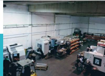
Especialista en mecanizado de precisión, mecanizado en serie y piezas composite. Cuentan con un equipo técnico de nueve personas con tres centros de mecanizado, dos centros de torneado, rectificadora plana, torno paralelo, fresadora-punteadora, sierra automática, taladro de columna y roscadora, todo ello en un recinto de 400 m<sup>2</sup>. Trabajan con todos los sectores clientes y materiales.
