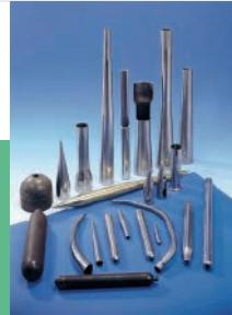
MECALTUB se dedica al conformado de piezas de tubo metálicas (conificado, reducción y abocardado) aplicadas en diversos sectores tales como la construcción, el mobiliario, la iluminación, las motocicletas, la automoción, bicicletas, etc. Principalmente, realizan el conformado de piezas con máquinas martilladoras (conificadoras) y prensas hidráulicas.
