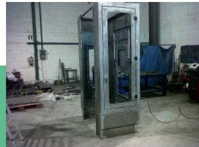
CALDERERÍA ANBOTO es una empresa especializada en la fabricación de carenados y bancadas para máquina herramienta. Se dedica a la fabricación, montaje e instalación de estructuras metálicas, calderería fina y semipesada. Trabajan en acero inoxidable y aluminio. Trabajan todos los sectores y están especializados en el sector de la máquina-herramienta.
