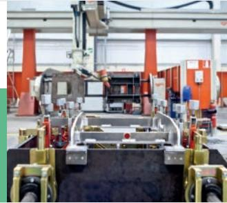
Empresa dedicada a la transformación de productos metalúrgicos, siendo su especialidad el corte láser y punzonado, plegado y calderería (tig, mag) y mecano soldados. Trabaja el acero al carbono, inoxidable y aluminio. Cuenta con 23.000 m<sup>2</sup> y túnel de pintura al polvo. Los sectores a los que se dirige son el eólico, ferroviario, frío industrial y sistemas de elevación.
