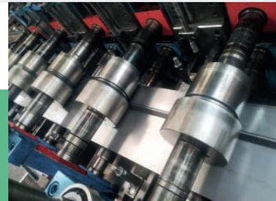
Empresa especializada en la fabricación de perfiles conformados por laminación en frío. Sus instalaciones están compuestas por once líneas de perfilado con cuatro líneas de punzonado. Cuentan con un taller mecánico propio donde diseñan y fabrican sus propios útiles y rodillos. Cuentan con flexibilidad y capacidad de adaptación a necesidades especiales.
