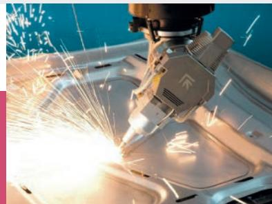
La actividad principal de FERVILOR es el corte láser, plegado y calderería para la fabricación de chasis y partes de autobuses. En sus instalaciones cuentan con cuatro máquinas de corte en plano y tres más de corte en tubo y dos de láser 3D, así como con cuatro plegadoras de CNC, junto con una sección de soldadura y mecanizado.
