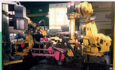
En TALLERES FELAS cuentan con la siguiente maquinaria: prensas excéntricas e hidráulicas de 25 a 800 Tn, tornos CNC que entallan o repulsan, centros de mecanizado, tornos paralelos CNC, fresadoras, taladros, rosadoras. En cuanto a instalaciones de soldadura: robotizados, soldadura TIG, MIG, microplasma, eléctrica. Todo ello ubicado en unas instalaciones de más de 10.000 m<sup>2</sup>.
