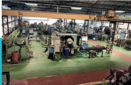
Empresa especializada en el mecanizado de precisión sobre plano o muestra. Ofrecen soluciones personalizadas porque orientan su trabajo a las necesidades de los clientes. Dispone de una capacidad de torneado de Ø730x11000 mm.
